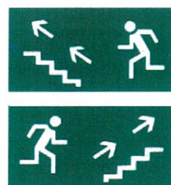
Kierunek do wyjścia drogi ewakuacyjnej schodami w górę
