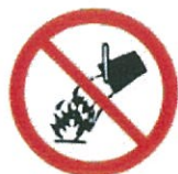
Zakaz gaszenia wodą
